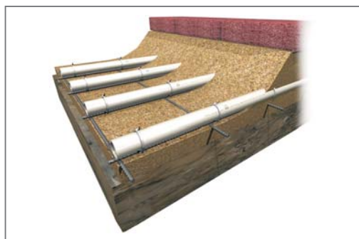
Напольное отопление на открытых пространствах
