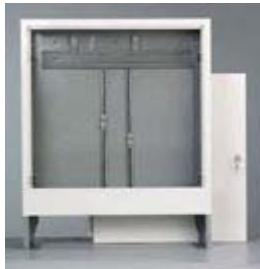
Purmo предлагает два вида распределительных шкафчиков: под штукатурку и на штукатурку. Шкафчики изготовлены из оцинкованного металлического листа. Специальная антикоррозионная краска дополнительно предохраняет их от коррозии. Они окрашены в белый цвет, очень эстетичны и просты для монтажа. Дверца закрывается на ключ, высоту и глубину шкафчика можно регулировать. Ширину необходимо выбирать в зависимости от числа спроектированных контуров.
