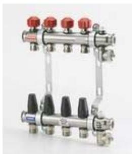
Наиболее эксклюзивной моделью (с индикаторами расхода) является никелированная. Распределители Purmo поставляются в полностью собранном виде. В процессе производства каждый экземпляр проверяется на герметичность под давлением 8 бар.
